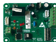
Согласователь работы двух кондиционеров YCJ-A002*
