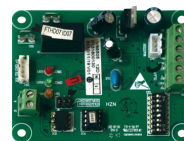
Согласователь работы двух кондиционеров YCJ-A002*
