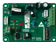
Согласователь работы двух кондиционеров YCJ-A002*
